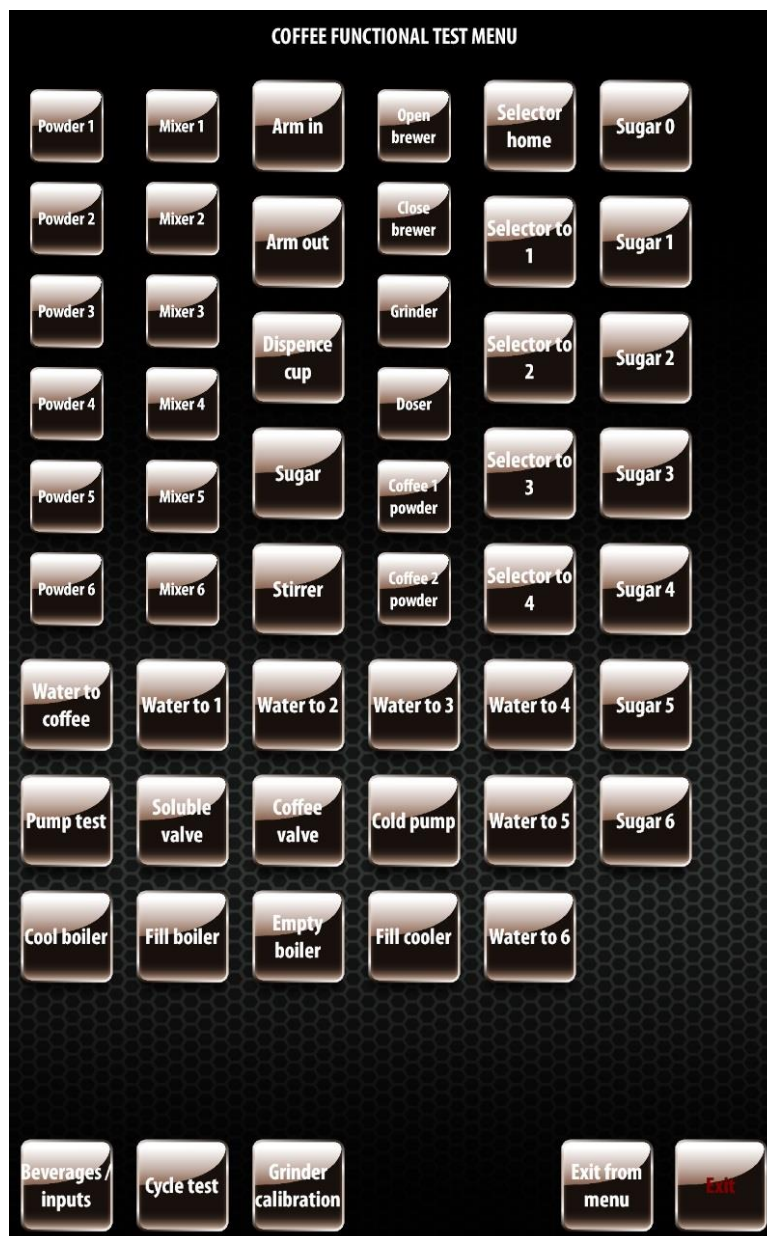
Рисунок 17 — Меню функциональных тестов кофейника
